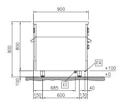
Electrical inlet (power) Equipotential screw
